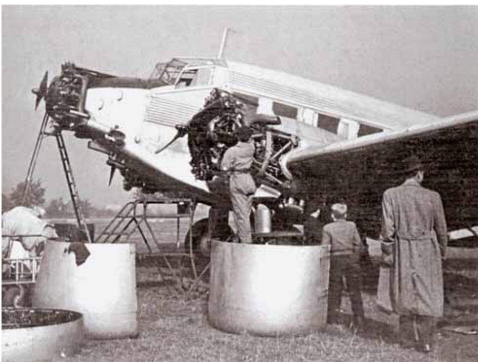
Vzácný snímek Junkerse Ju 52/3, nezapomenutelného svým potahem z vlnitého plechu. Létal na trati Ostrava–Olomouc–Praha a zpět a v Hrabůvce na něm mechanici prováděli údržbu. V těchto polních podmínkách nesměl mechanik při práci na prostředním motoru trpět závratí
