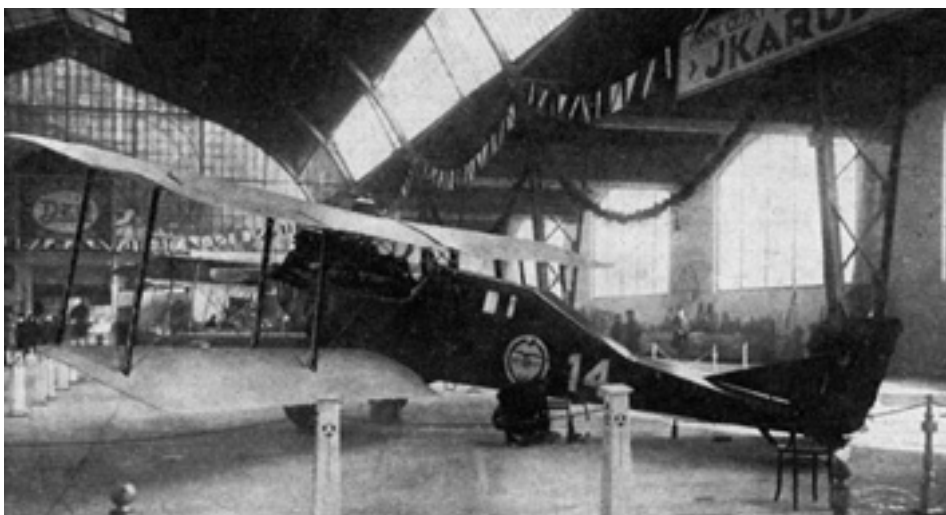
Přestavěný Brandenburg C.I s uzavřenou kabinou pro dva cestující společnosti Ikarus na I. mezinárodní letecké výstavě v Praze v roce 1920. Společnost letoun používala pro dopravu cestujících mezi Karlovými Vary a Mariánskými Lázněmi
