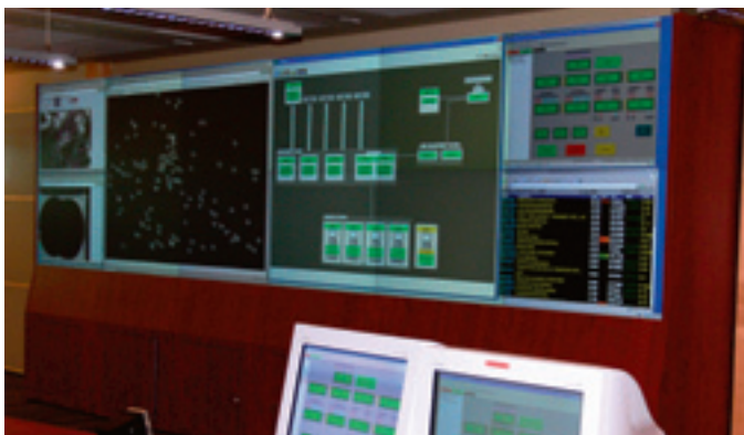
Na sále ITS byla dokončena montáž velkoplošného zobrazení BARCO. Nyní se podrobně nastavuje a doladuje celý systém, který bude zobrazením údajů systému CMOS (Centrální Monitorovací a Ovládací Systém) umožňovat dohled nad provozuschopností klíčových systémů nutných pro poskytování letových provozních služeb
